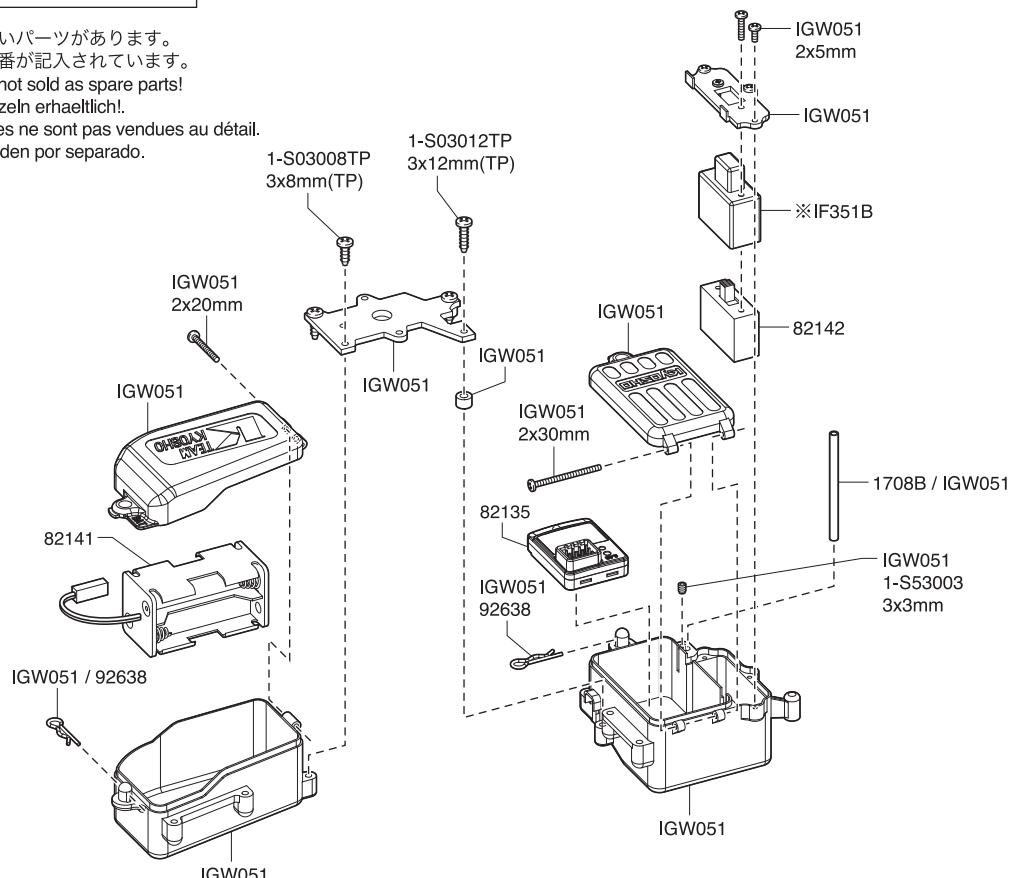
センターギヤボックス / Center Gearbox / Die mittlere Getriebegehäuse
